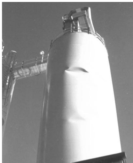
б) потеря устойчивости стен бункера, вызванная воздействием несимметричного потока при разгрузке
